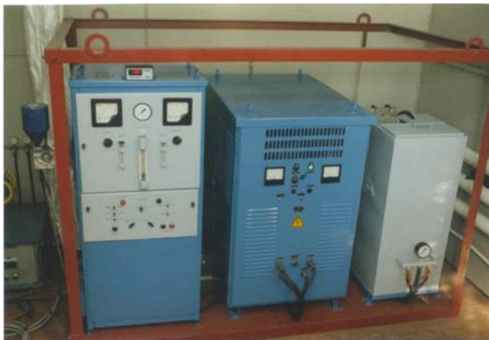
Рисунок 2.1 Комплекс плазмового напилення з установкою УПУ -3Д
