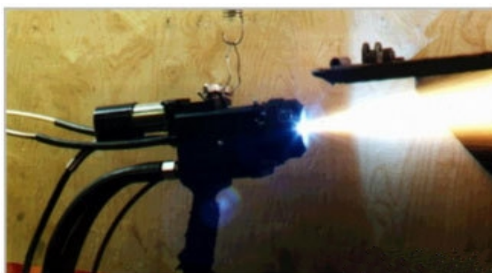
Рисунок 1.6 АДМ-апарат с камерою згорання. Напилення сталлюю проволокою
