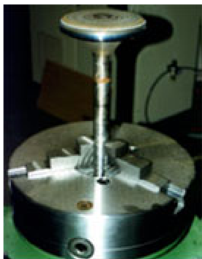
Рисунок 3.3 Очищення та притирання клапанів ДВЗ після напилення
