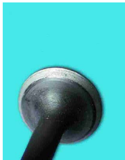
Рисунок 3.3 Очищення та притирання клапанів ДВЗ після напилення
