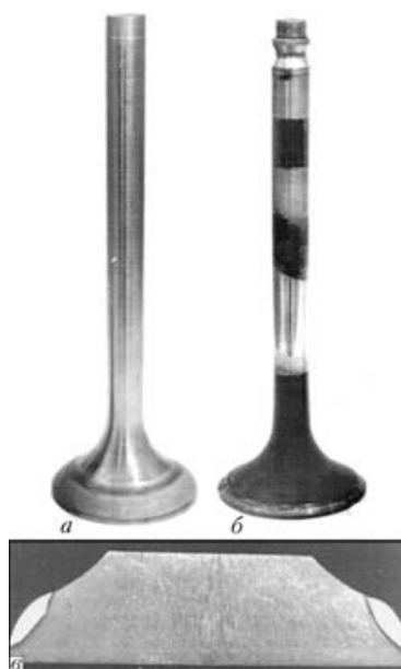
Рисунок 2.7 Зовнішній вигляд клапану дизельного двигуна 5Д70, наплавленого плазмово-порошковим методом сплавом 50НХ25С5Р, безпосередньо після наплавлення (а) і після 5000 год експлуатації (б) і макрошліфов наплавленого клапану (в)
