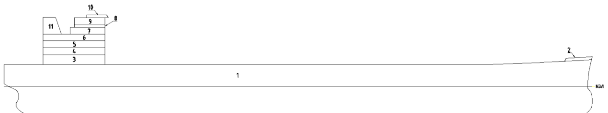
Рис. 2.3.2.1. – Схема визначення площі парусності
