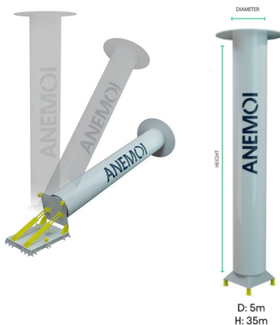
Рис. 2.13. Парусне вітрило фірми Anemoi.
