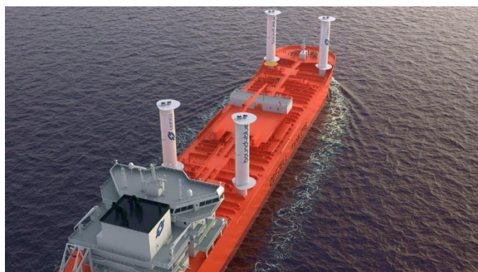
Рис.1.7. Вітрила з примусовою циркуляцією повітря
