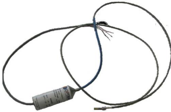
Рисунок 1.3. Датчик тиску ORTRAND (модель F333 94-Q-1) [19]
