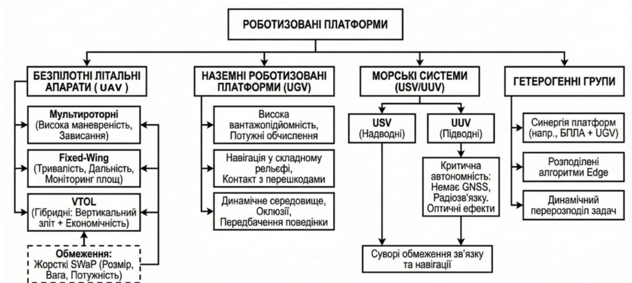
Рисунок 1.9 – Схема класифікації роботизованих платформ
