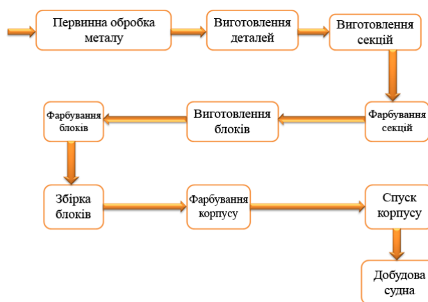
Рис. 3.9. - Принципова схема існуючого технологічного процесу побудови суден на суднобудівному заводі
