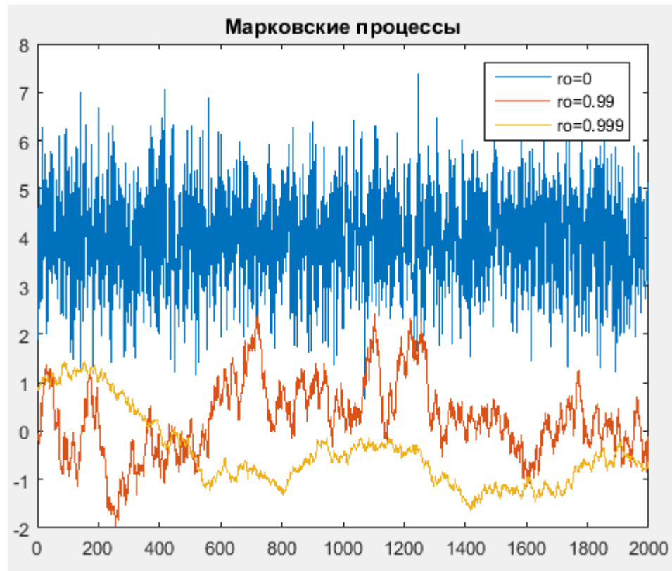
Рис. 4.8. Реалізації білого шуму і марківського процесу для двох значень часової кореляції
