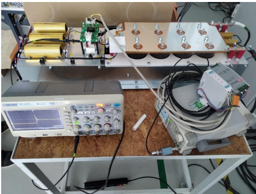
Рисунок 2 – Фотографія чоппера при його випробуваннях
