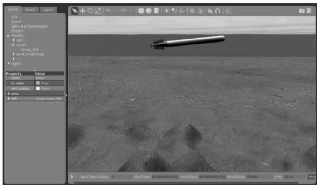
Рисунок 3 – Модель АНПА у віртуальному світі, реалізована у пакеті моделювання Gazebo
