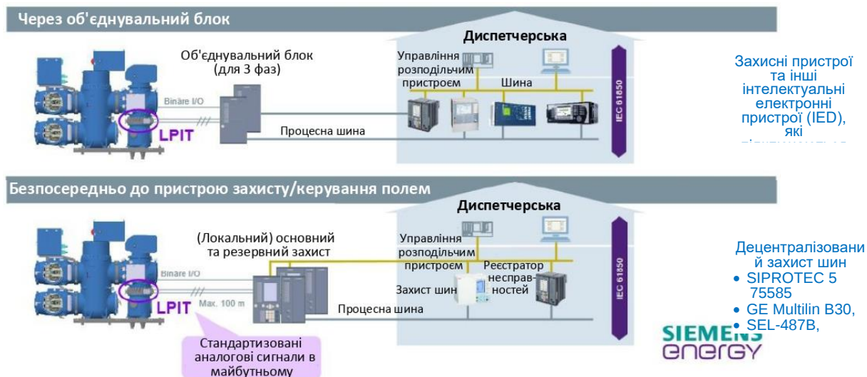
Рисунок 3 – Шляхи до технологій захисту та наведення: через об'єднаний підрозділ і безпосередньо до пристрою захисту/керування полем
