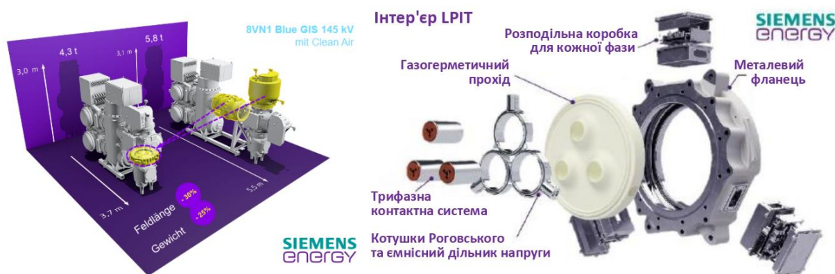
Рисунок 2 – Підстанція 8VN1 на номінальну напругу 145 кВ і інтер'єр LPIT
