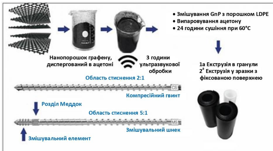
Рисунок 3 – Схематичне зображення процесу підготовки зразків
