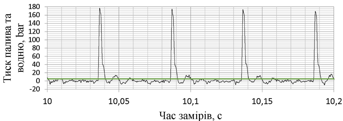
Рис. 3.20 Діаграма впорскування палива без додавання водню
