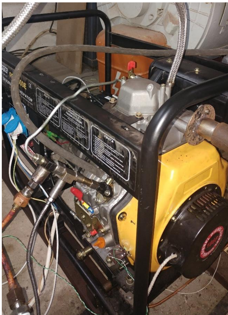
Рис. 3.3 Випробувальний стенд на базі двигуна 1Ч8,6/7,2
