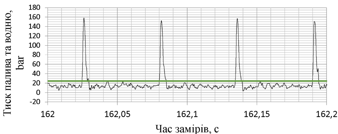
Рис. 3.24 Діаграма впорскування палива при тиску подачі водневої домішки 0,2 МПа
