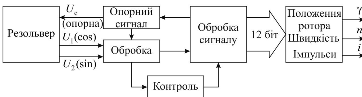
Рисунок 3.6 – Обробка вихідного сигналу резольвера
