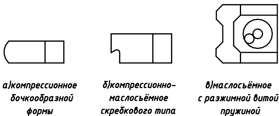
Рисунок 3.3 Профілі компресійних і маслознімних кілець.
