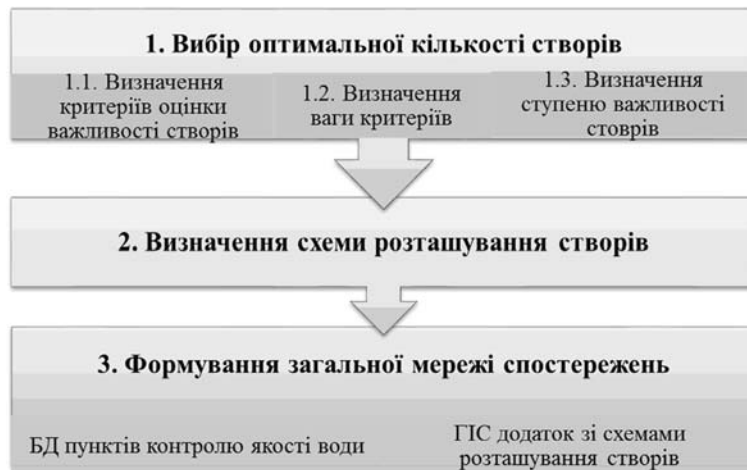
Рис. 1. Блок-схема алгоритму формування комп'ютерної мережі спостережень за якістю поверхневих вод акваторії БДЛК
