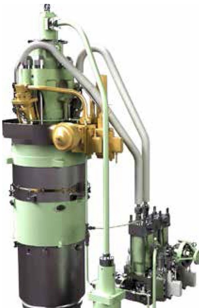
Рисунок 3.3 – Кришка циліндрів, оснащена інжекторами паливним підсилювачем та блоком керування LGI (всі труби паливного блоку є двостінними)
