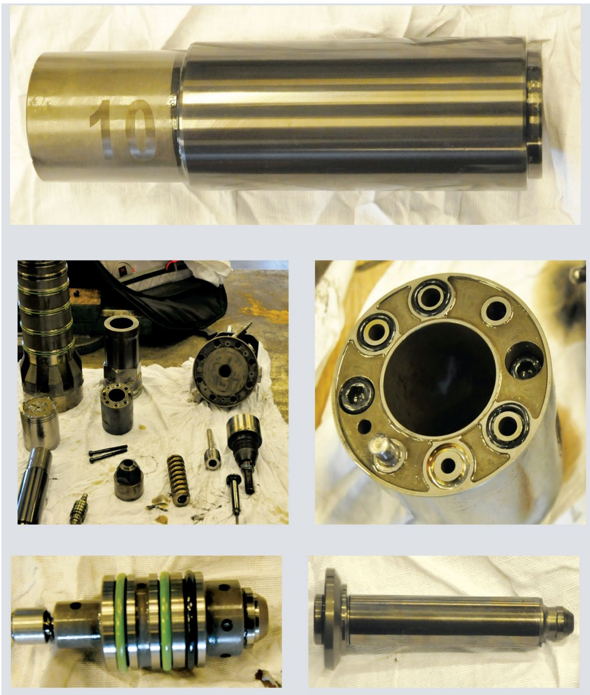
Рисунок 3.10 – Частини, демонтовані після випробування на метанолі
