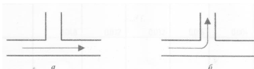
Рисунок 6.4. Трійники: а) прямоточний, б) непрямоточний
