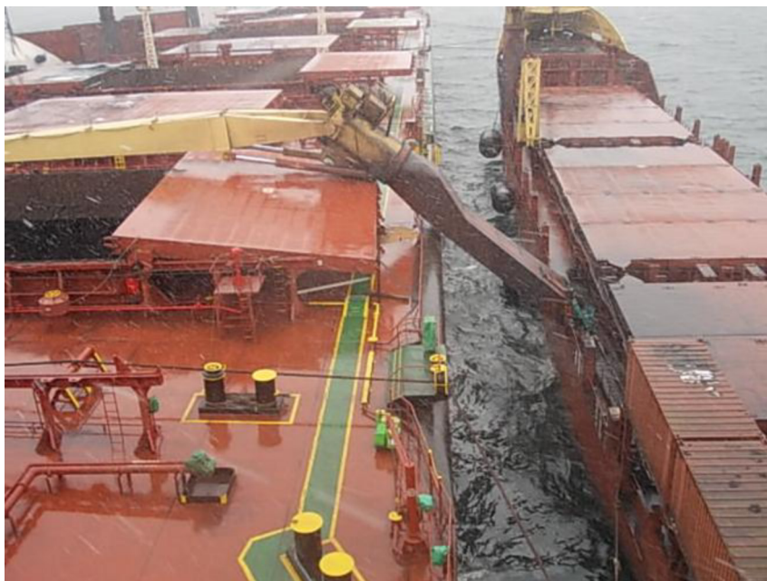
Рис. 1. Загальний вигляд руйнування стріли суднового перевантажувального крана
