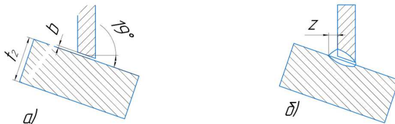
Рис.1.8 З'єднання № 5 а) – складання, б-зварне з'єднання Т1(ГОСТ 14771-76)
