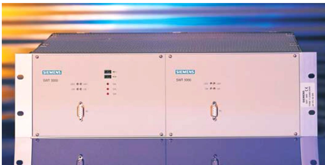
Рисунок 1.4 – Система передачі сигналів захистів SWT3000
