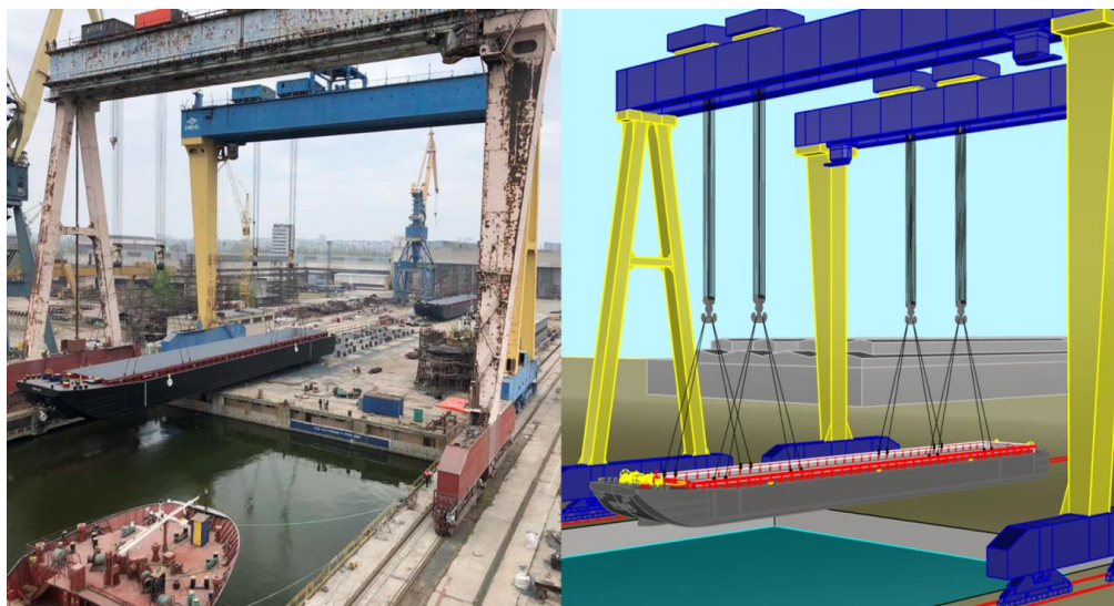
Рис. 1.4 - Приклади моделювання виробничих процесів: а – укрупнення корпусу судна, б - спуск півкорпусу судна на воду
