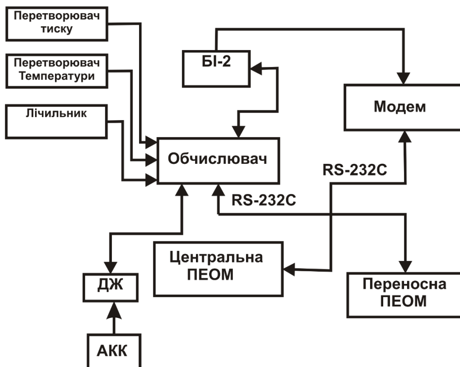
Рисунок 1.6 – Функціональна схема Комплексу у варіанті виконання 2 (з перетворювачами вимірювання тиску, температури, різниці тисків) при обслуговуванні одного трубопроводу.
