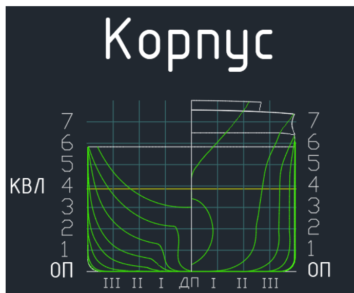
Рисунок 2.2 – Проекції теоретичної поверхні корпусу балкера: а) бік; б) напівширота; в) корпус
