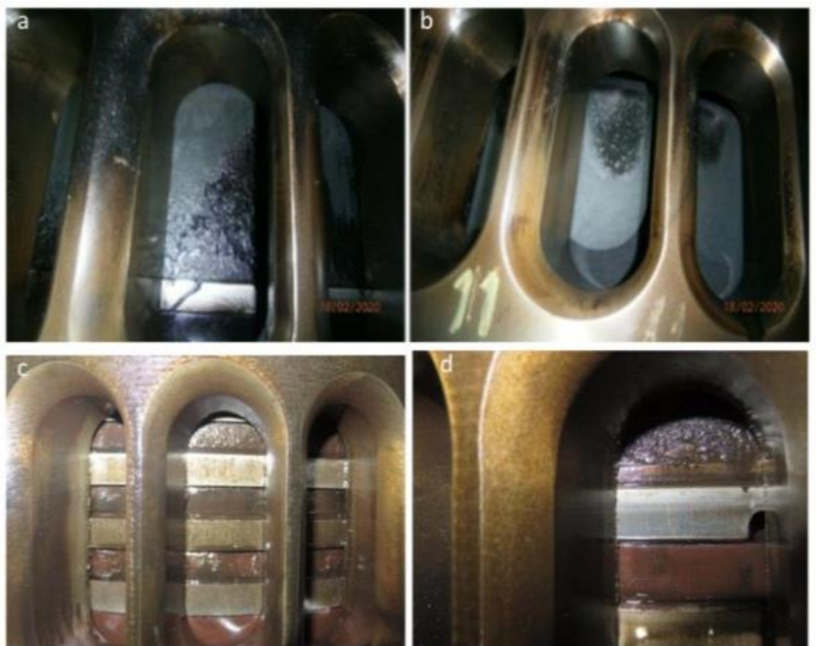
Рис 5.2 Протертість та знос гільзи та кілець циліндра
