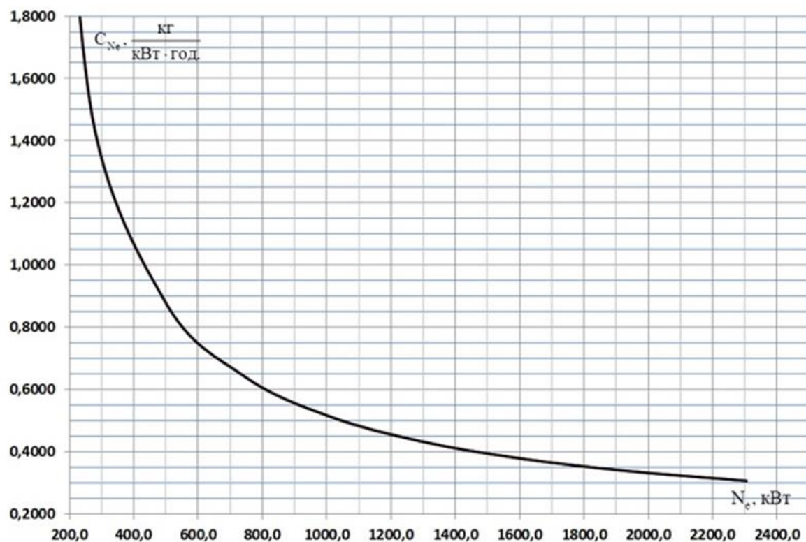
Рис. 22. Залежність питомої витрати палива на ГТА від його потужності на клеммах генератора
