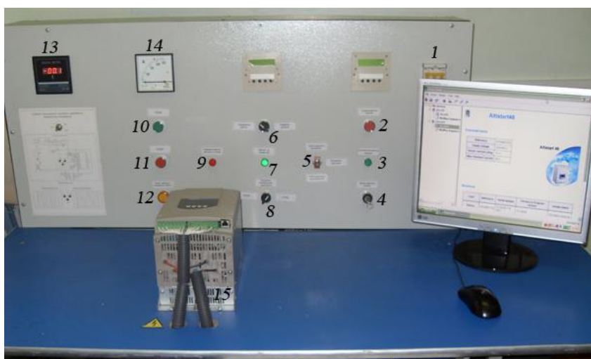
Рисунок 3.5 – Лабораторний стенд для дослідження процесів плавного пуску асинхронних двигунів
