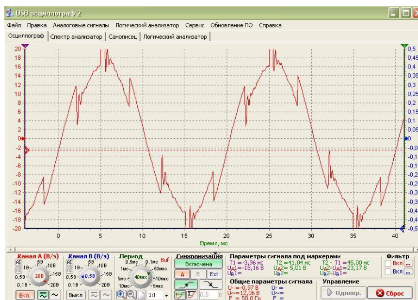
Рисунок 3.13 – Осцилограма статорної напруги при завершенні розгону двигуна
