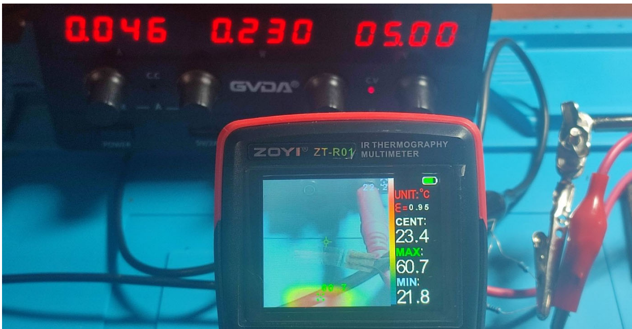
Рисунок 2.2 – Вимірювання температури тензорезистора тепловізором.
