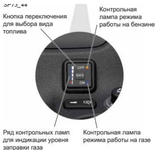
Рисунок 3.23 – Інтерфейс газового обладнання
