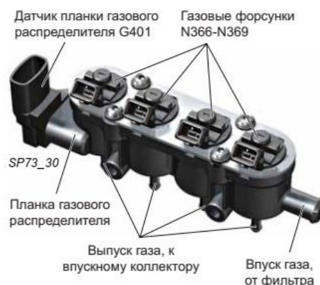
Рисунок 3.18 – Блок форсунок (використовується в багаточиліндрових двигунах)
