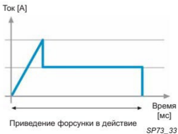
Рисунок 3.20 – Сигнал, що подається на газові форсунки
