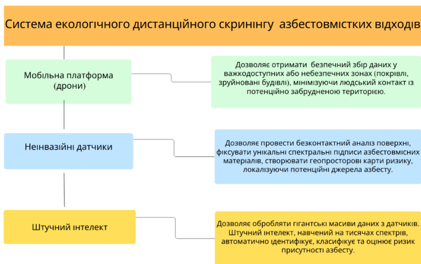
Рис 1. Система екологічного дистанційного скринінгу азбестовмісних відходів
