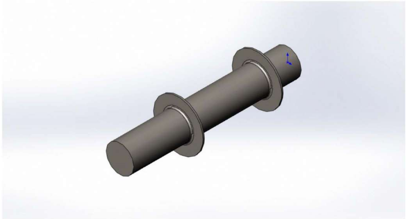
Рисунок 8.7 - Розрахункова модель вала якірної лебідки
