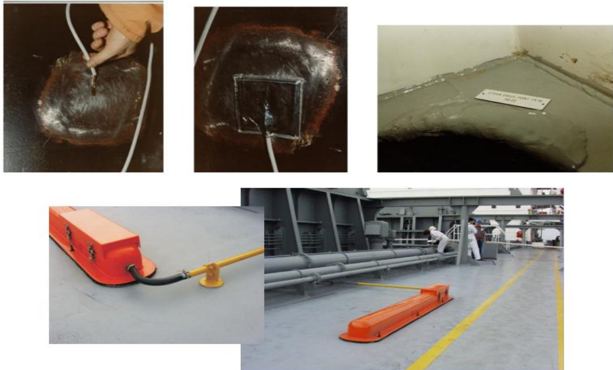
Рис. 6.6. Типові приклади встановлення сенсорів на корпусі судна
