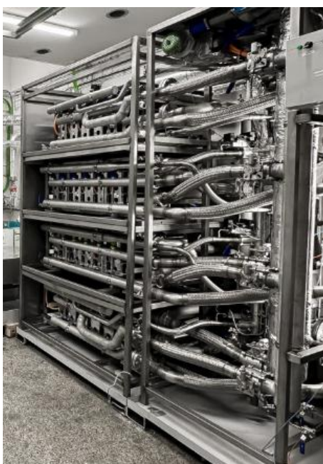
Рис.4.7. Blue World's methanol fuel cell system серії S,
