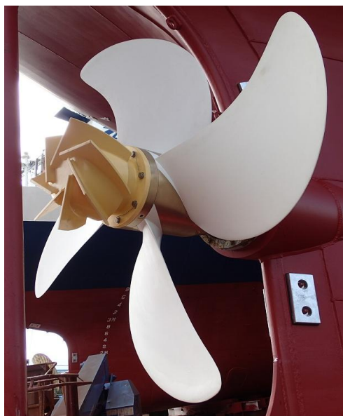
Рис. 2.6. Carbon Fiber Reinforced Polymer Propeller (Полімерний гвинт, армований вуглецевим волокном)
