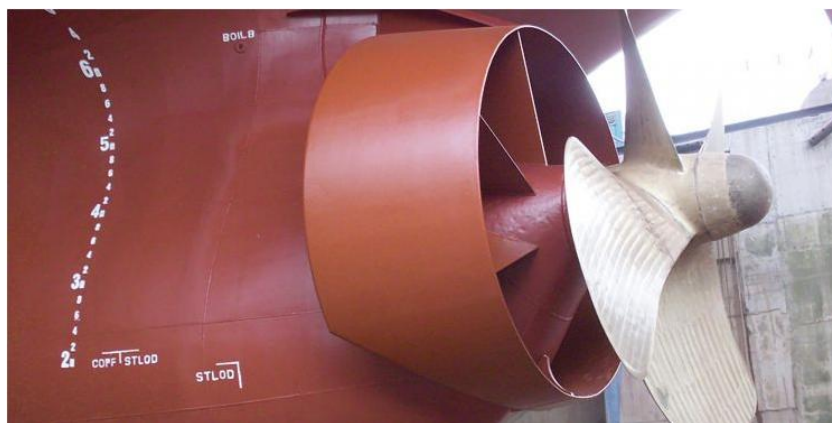
Рис. 2.7. Becker Mewis Duct (спрямовуючий канал гвинта)
