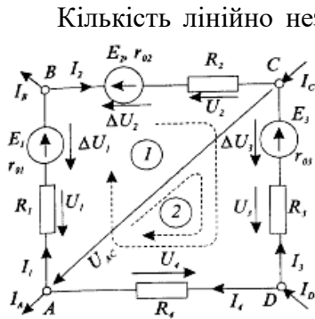
Рис. 1.31. Замкнутий контур деякої електричної схеми зі скеруванням E, I, U
