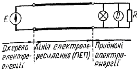
Рис. 1.21. Схема простого електричного кола
