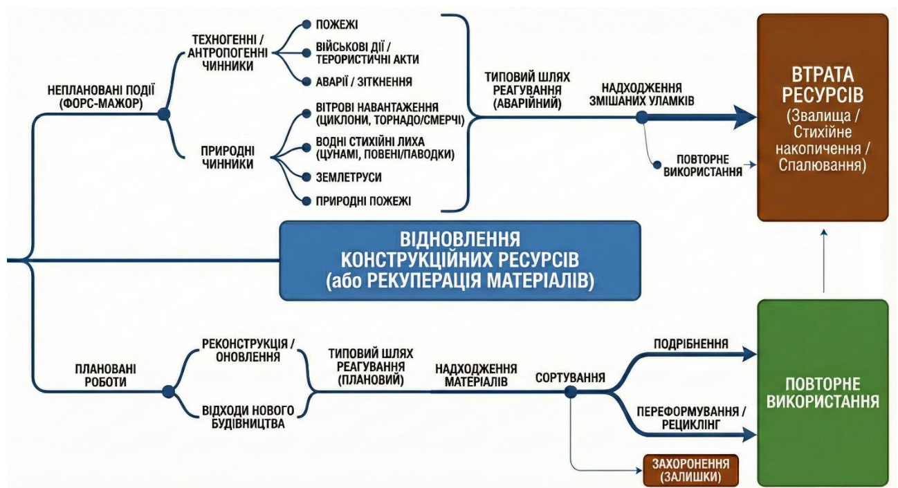
Рис. 4.3 – Концептуальна схема руху матеріальних потоків: порівняння планованих та аварійних сценаріїв
