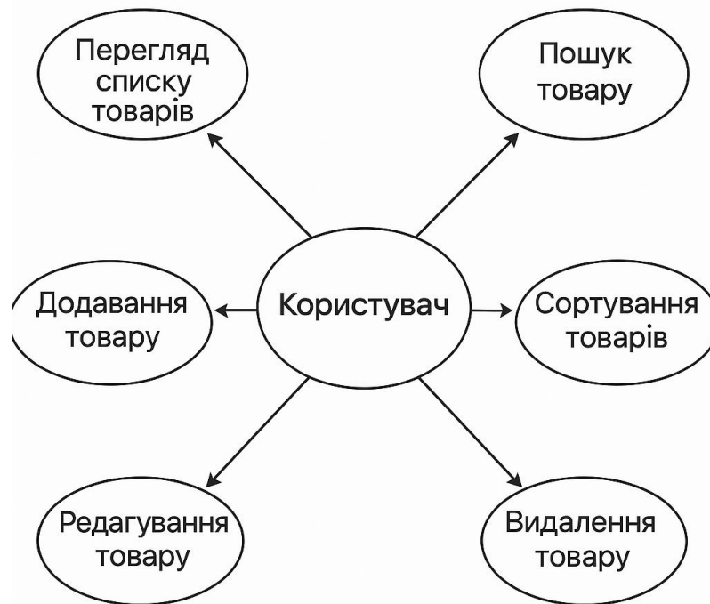
Рисунок 2.6 – Схема варіантів використання інформаційної системи з боку користувача
