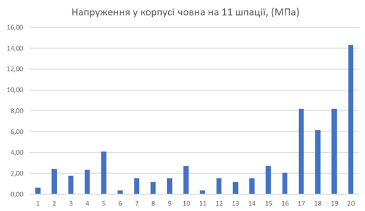
Рисунок 3.6 – Напруження у корпусі човна на 11 шпації, (МПа)
