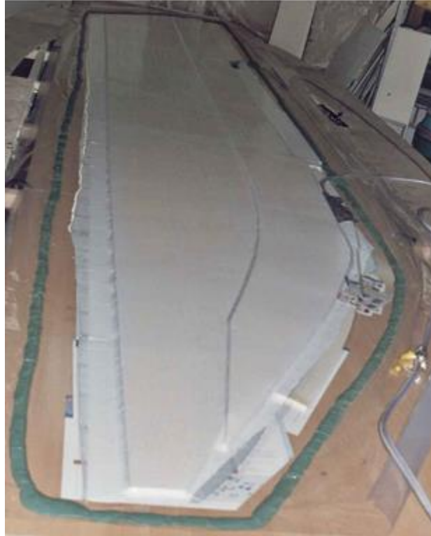
Рисунок 1.14 Формування панелі методом вакуумного формування
