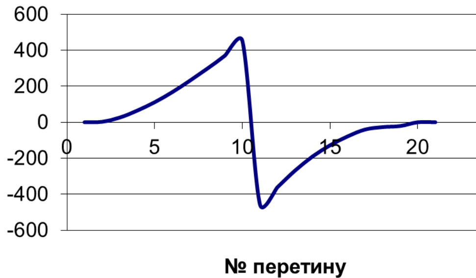
Рисунок 3.4. Розподілене навантаження на корпусі човна (кН/м).
