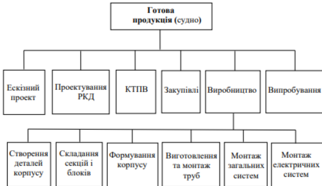
Рис..2.1. Структура проєкту побудови судна: КД – робоча конструкторська документація, КТПВ – конструкторсько-технологічна підготовка виробництва
