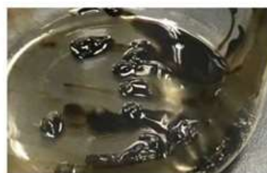
Рисунок 4 – Парафиновые отложения в топливном фильтре
