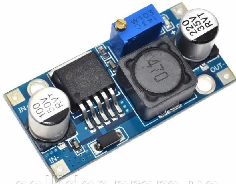
Рисунок 3.9. – Модуль пониження напруги LM2596 від 4-35 В до 1-26 В, максимальна потужність 3А
