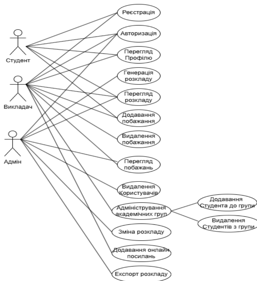
Рисунок 2.1 - Діаграма варіантів використання програмного застосунку для автоматизації формування розкладу занять в університеті «Розклад занять в НУК»
