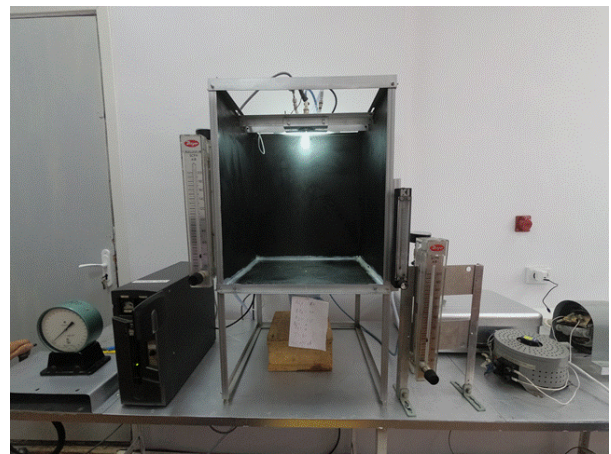
Рис. 5. Фотографія експериментального стенду при роботі слабкострумного плазмового генератора
