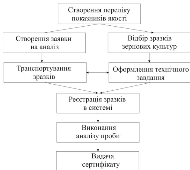
Рис. 4. Загальний алгоритм дій при проведенні аналізів зернових та олійних культур
