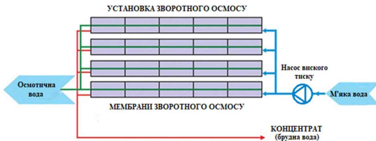
Рисунок 1.2. Типова схема фільтру зворотного осмосу
