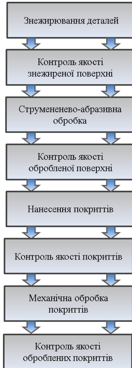
Рисунок 4.1 – Технологічна схема електродугового напилення композиційних покриттів
