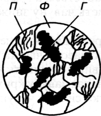
Рисунок 10.6 - Схема мікроструктури чавуна з вермикулярним графітом та феритно-перлітною металевою основою: П – перліт, Ф – ферит, Г – вермикулярний графіт
