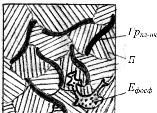
Рисунок 10.5 - Схематичне зображення сірого чавуну з перлітною металевою основою: Гр_{пл-нч} – графіт пластинчастий, П – перліт, Е_{фосф} - потрійна фосфідна евтектика, Е_{фосф} = Fe_3P + Fe_3C + Fe
