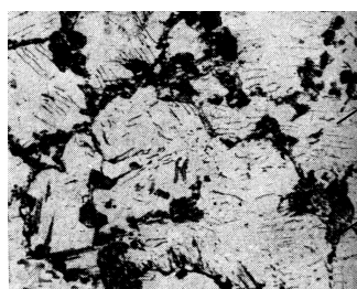
Рисунок 14.4 - Мартенсит і тростит гартування, при V_{\text{гарт.}} < V_{\text{кр.}}
