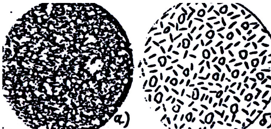
Рисунок 17.6 - Сталь Р18 після гартування і трикратного відпускання: а – мікроструктура ( \times 500 ); б – схема мікроструктури
