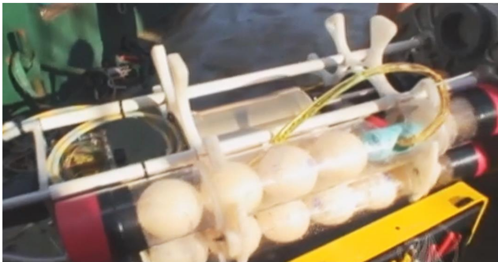
Рис. 1.4. Керамічні сфери, вкладені у відсік плавучості. [20]
