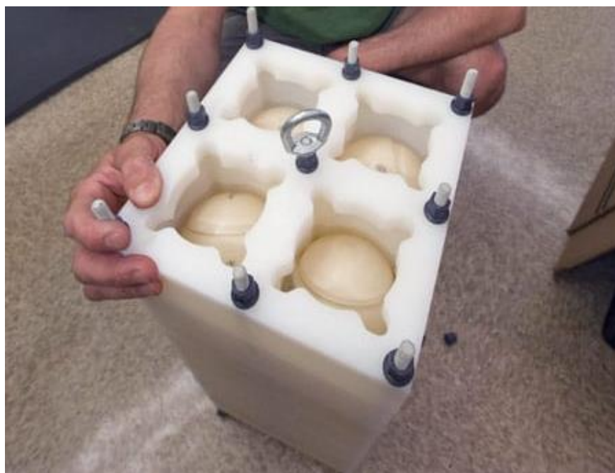
Рис. 1.3. Блок плавучості з керамічними макросферами. [20]
