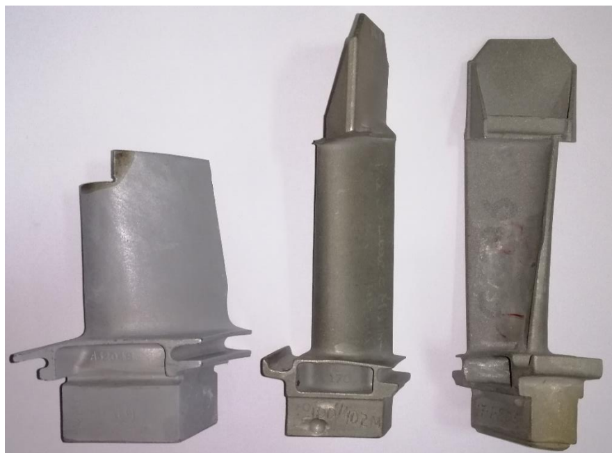
Рисунок 1.3 – Загальний вид зразків лопаток ГТД, виготовлених із ЖНС CM93-BI ( a ) і CM96-BI ( б )
