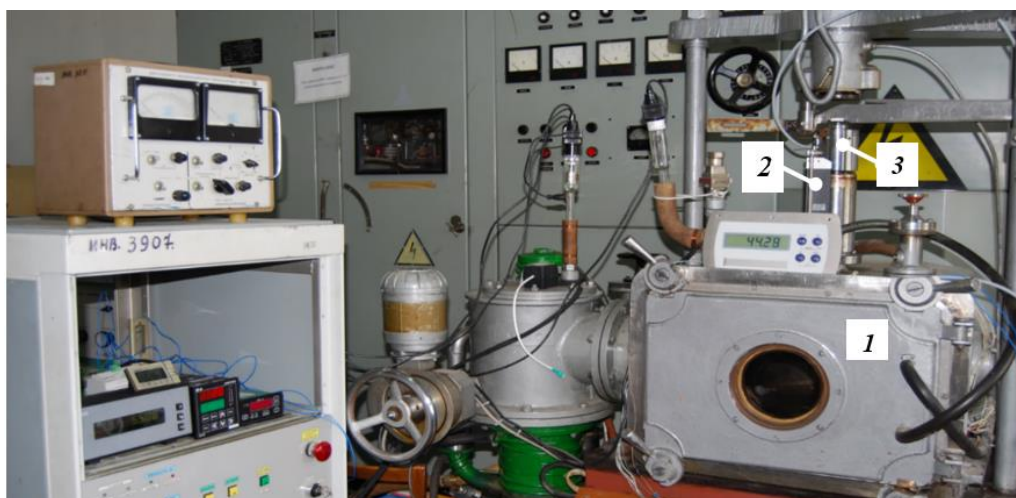
Рисунок 2.1 – Робоча камера установки УДСВ-ДТ після модернізації: 1 – вакуумна камера; 2 – датчик переміщення; 3 – датчик навантаження
