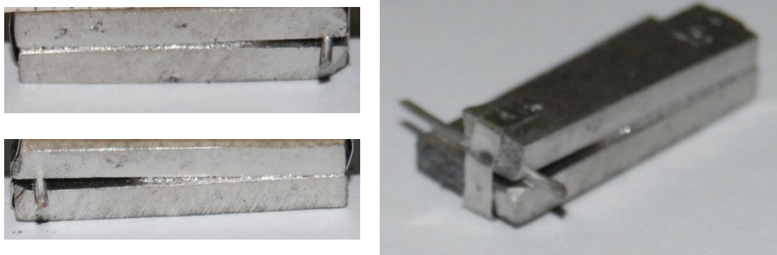
Рисунок 4.8– Клиноподібні зразки для визначення затікання припою в зазор різної величини
