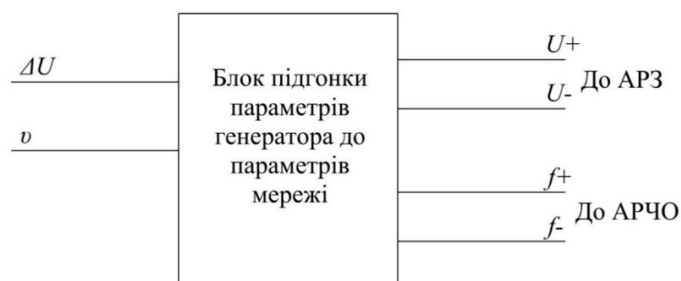
Рисунок 2.7 – Структурна схема блоку підгонки параметрів СГ до параметрів мережі
