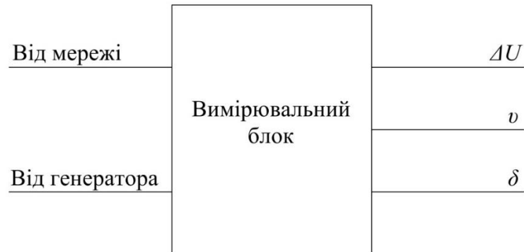
Рисунок 2.6 – Структурна схема вимірювального блоку
