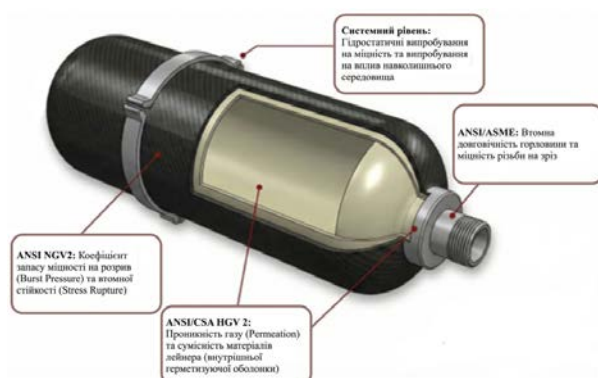
Рис. 3. Структурна схема COPV (Type IV) у контексті нормативних вимог сімейства ANSI
