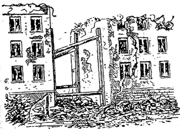
Мал.8.4. Укріплення стіни розпівками, що встановлюються між пошкодженою стіною і стійкою стіною суміжного будинку
