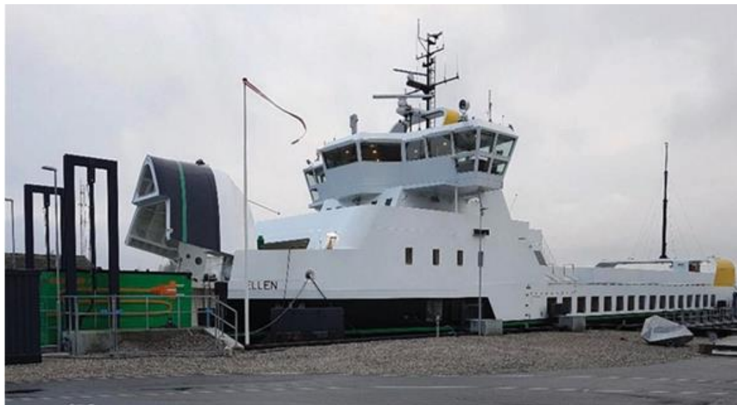
Рисунок 1.6.7. — Зарядна станція на базі постійного струму Mobimar Nectors для E-Ferry Ellen.
