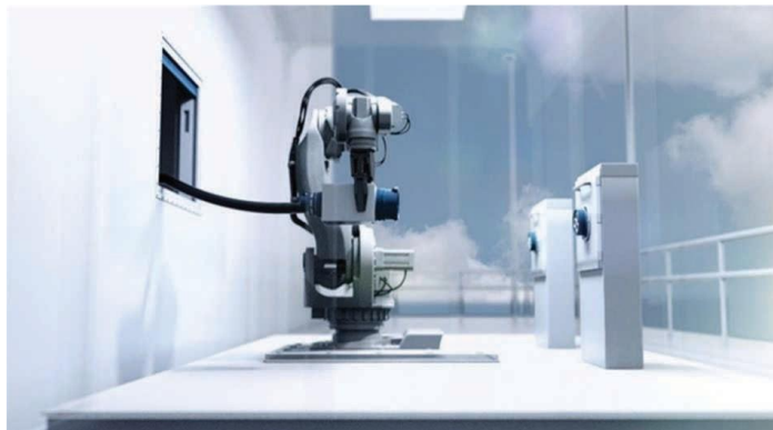
Рисунок 1.6.2 – ABB IRB7600, автономна робота-рука, яка використовується для зарядки MS Aurora та MF Tycho Brahe
