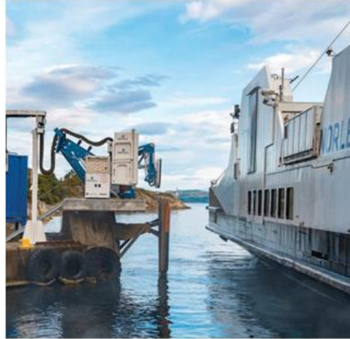
Рисунок 1.6.9. – Індуктивна зарядна система Wärtsilä для зарядки MF Folgefönn
