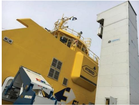
Рисунок 1.6.4. – Вежа автоматизованої роз'ємної системи Cavotec, що використовується для зарядки MF Elektra
