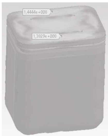
Рис. 3. Розподіл еквівалентних напружень у корпусі контейнера разом із кришкою
