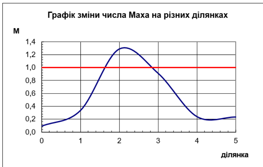
Рис.5.14. Зміна параметрів повітря по ділянках компресора
