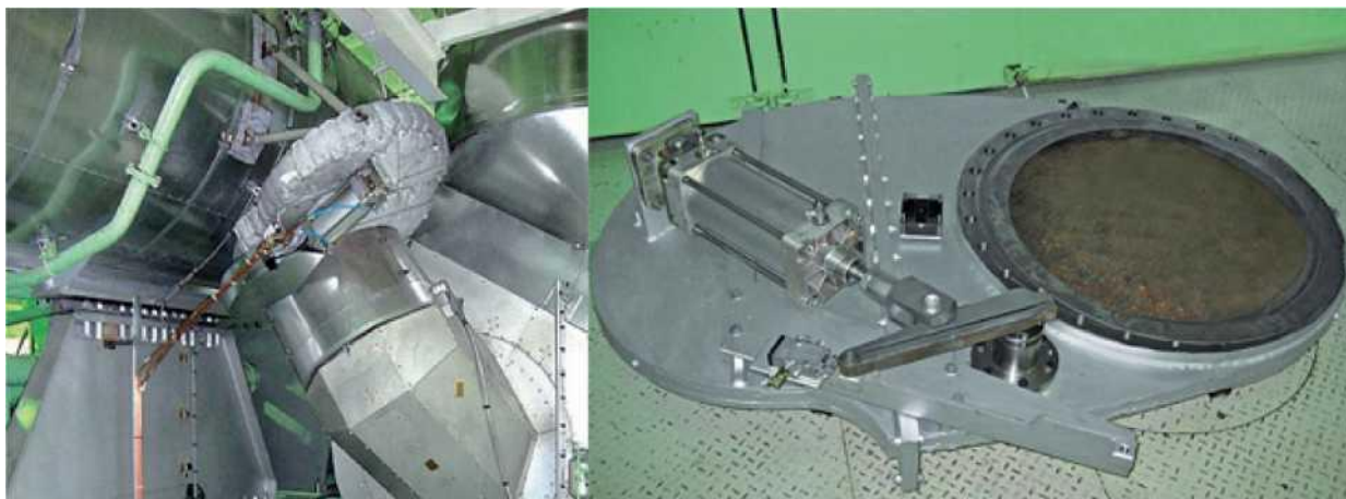
Рисунок 2.4 Встановлення клапана (поворотного затвора) на двигуні «MAN Diesel and Turbo» серії ME і його загальний вигляд
